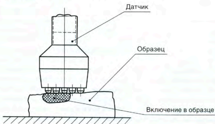
Рис. 2.8. Принцип действия тактильного устройства
