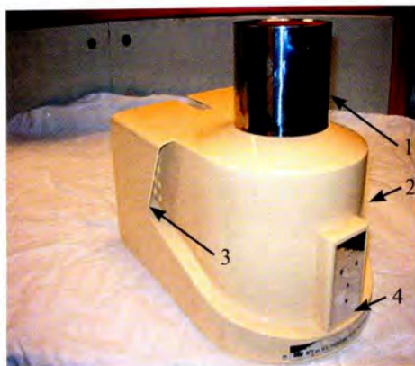
Рис. 3.52. Механорецептор: 1 — предметный столлик; 2 — кожух; 3 — вентиляционные отверстия; 4 — индикаторная панель
