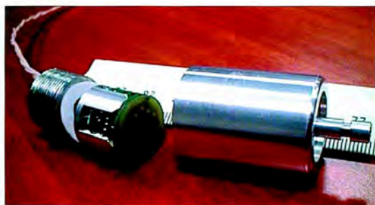
Рис. 3.39. Фотография сборки МИПД-19 в узел обработки для измерения локальных давлений
