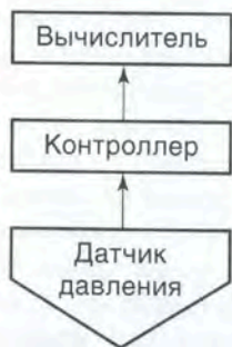
Рис. 3.2. Типовая схема измерительной системы
