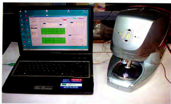
Рис. 3.62. Стационарный тактильный механорецептор с программным обеспечением
