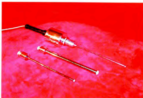
Рис. 3.33. Эндоскопический тактильный прибор со сменными зондами различного диаметра
