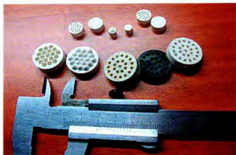
Рис. 3.19. Мембраны чувствительного элемента тактильного прибора
