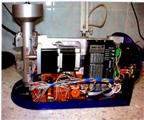
Рис. 3.59. Конструкция стационарного тактильного механорецептора с использованием шагового двигателя и механизма перемещения предметного столика на подшипниковых направляющих
