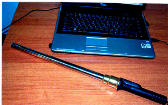
Рис. 3.13. Внешний вид эндоскопического тактильного прибора (I)
