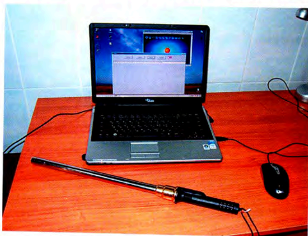
Рис. 3.16. Внешний вид эндоскопического тактильного прибора (IV)
